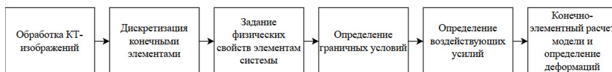
Рисунок 1.1 – Схема взаимодействия этапов работы приложения
