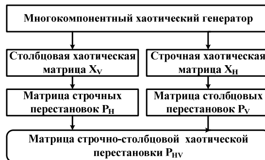
Рисунок 1.2 – Блок-схема генератора матриц хаотических перестановок
