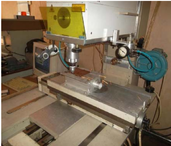
Рисунок 1.1 – Процесс вырезания лазером YAG маски из пластины нержавеющей стали 08Х18Н10
