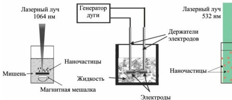
Рисунок 1 – Схема экспериментов для синтеза наночастиц методом лазерной абляции и в электрическом разряде в жидкостях
