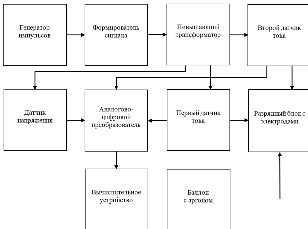
Рисунок 1.1 – Структурная схема исследовательского стенда
