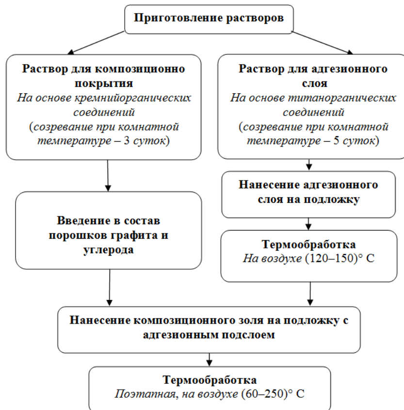
Рисунок 1.1 – Схема получения композиционных светопоглощающих покрытий
