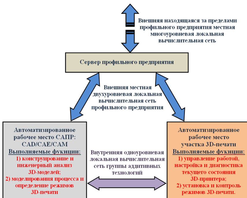
Рисунок 1.3 – Структурная схема организуемого на базе группы аддитивных технологий элементарного интегрируемого аддитивного производства
