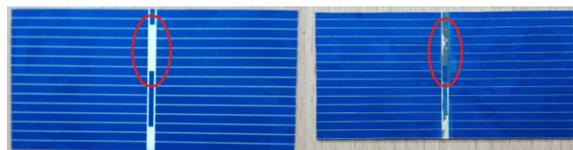
б) – вид контактных площадок до испытаний (слева) и после воздействия температуры испытаний 180° С (справа)
