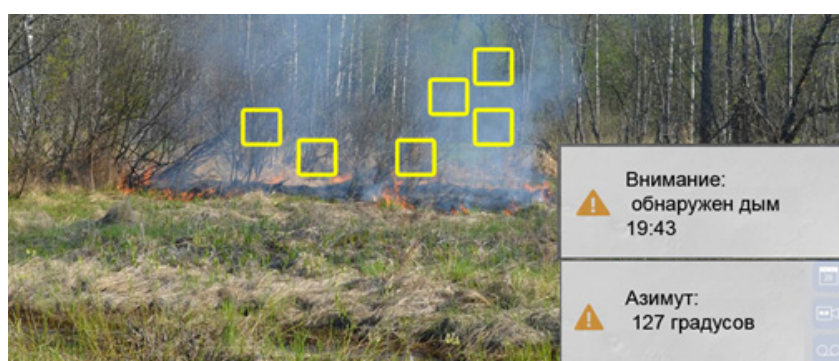
Рисунок 2.2 – Пример пользовательского интерфейса программного обеспечения и работа контроллера по автоматическому вычислению азимута очага возгорания
