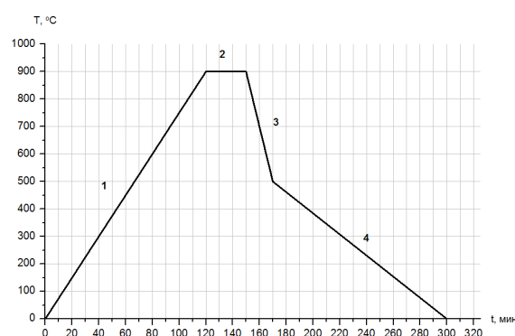
Рисунок 1.1 – Температурный график процесса спекания пеностекла: 1 – нагрев, 2 – плавление и образование пор, 3 – резкое охлаждение и стабилизация структуры, 4 – отжиг
