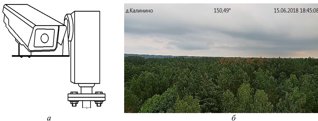
Рисунок 2.1 – IP-камера на опорно-поворотной платформе на вертикальном кронштейне: а – способ монтажа видеокамеры на опорно-поворотной платформе; б – панорама лесного массива без «мертвой зоны»
