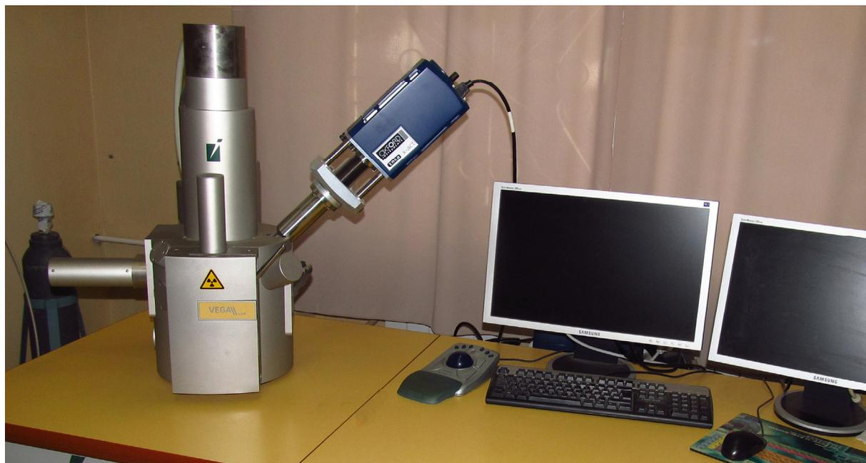
Рисунок 2.5 – Сканирующий электронный микроскоп VEGA II LSH
