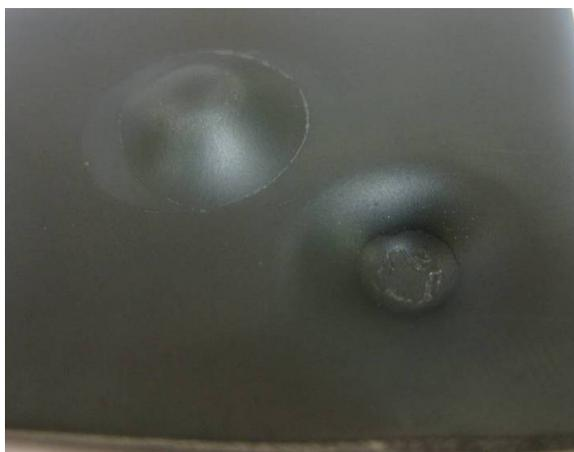
Рисунок 2.1 – Результат испытания на прочность SiO<sub>2</sub> покрытия армированного 30 масс.% порошка углерода при ударе
