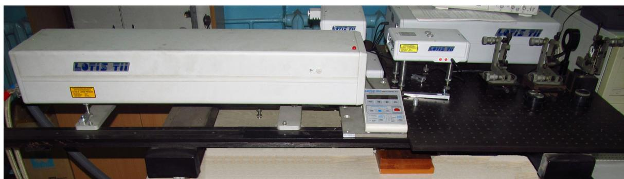
Рисунок 2.4 – Лазер LS-2134Y
