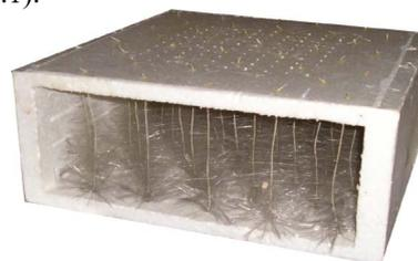
Рисунок 1.1 – Пенопластовый блок, содержащий конусовидные элементы из стекловолокна
