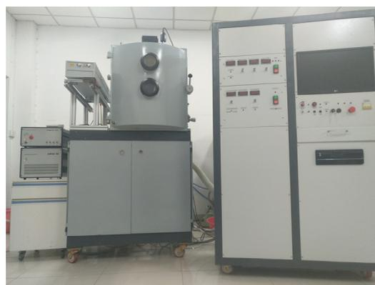
Рисунок 5.2 – Вакуумная установка для нанесения полимерных наноконпозиционных покрытий из газовой фазы методом электронно-лучевого диспергирования (2017)
