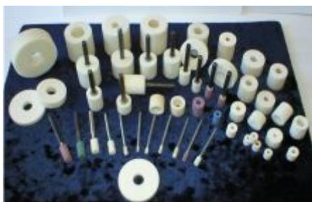
Рисунок 2.3 – Абразивный шлифовальный инструмент повышенной стойкости на керамической связке из первичного и вторичного абразива
