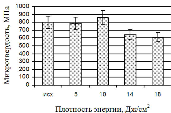
Рисунок 2.7 – Средние значения микротвердости на поверхности исходного образца и поверхности, обработанной плазмой с плотностью энергии 5–18 Дж/см 2 , при нагрузке 1 Н
