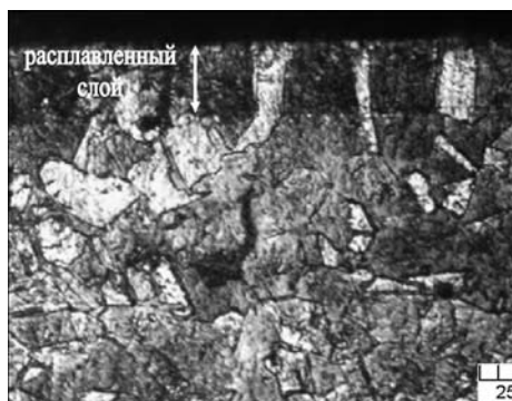
Рисунок 2.6 – Микроструктура поперечного шлифа образца меди М1 (степень деформации 35%), обработанного КПП с плотностью поглощенной энергии 14 Дж/см 2
