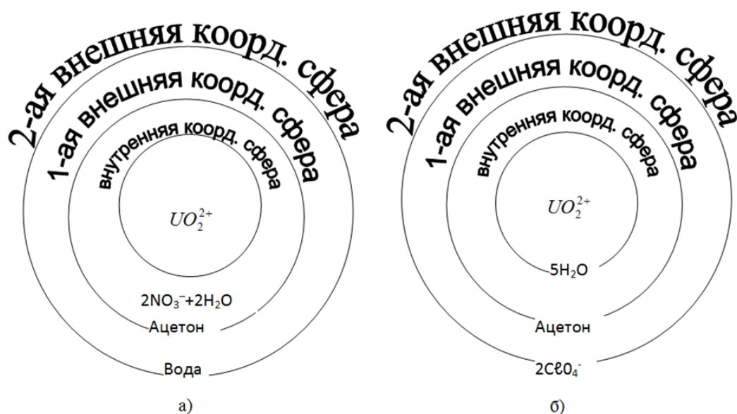
Рисунок 0.3 – Предполагаемая структура координационного окружения иона UO_2^{2+} в растворах дигидрата уранилнитрата (а) и перхлората уранил (б) в ацетоне
