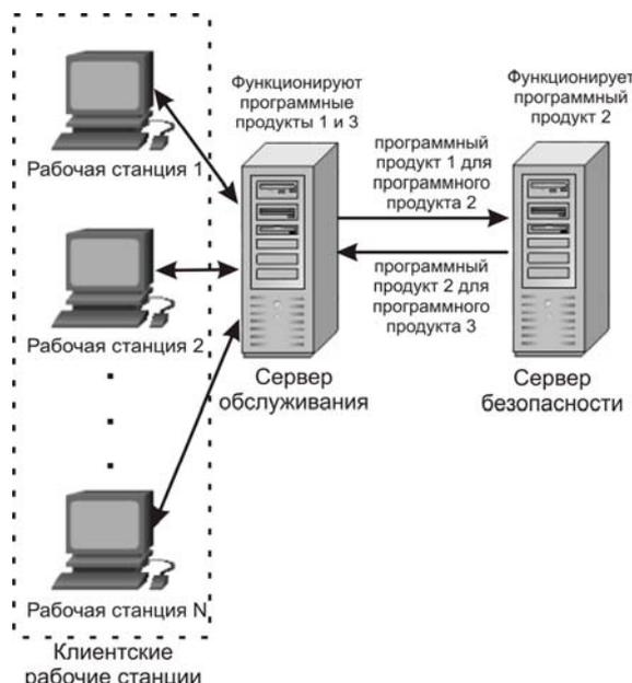
Рисунок 3 – Схема программного комплекса мониторинга активности пользователей для технологии «тонкий клиент».
