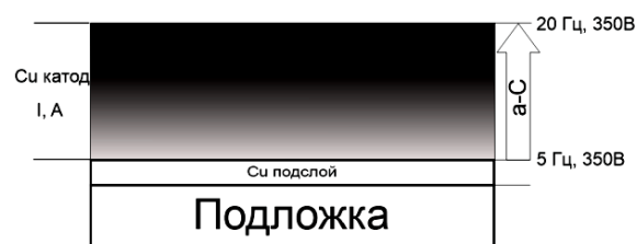
Рисунок 1.1 – Схематическое изображение медь-углеродного покрытия, осажденного на медный подслои
