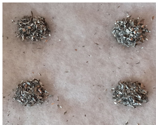
Рисунок 1.1 – Внешний вид сверху элементов, сформированных из алюминиевой стружки и размещенных на поверхности фрагмента синтетического нетканого волокнистого материала
