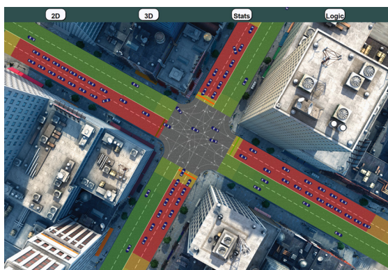
Рисунок 1.5 – Модель перекрёстка в процессе имитации (2D)
