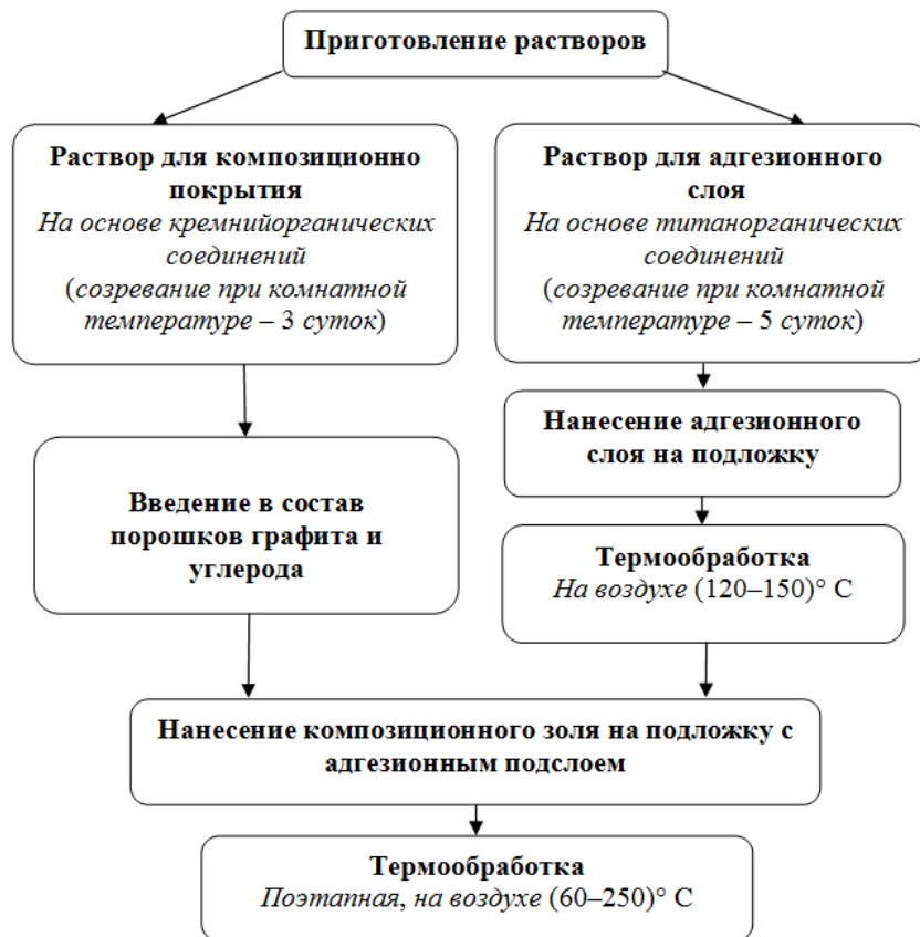
Рисунок 1.1 – Схема получения композиционных светопоглощающих покрытий
