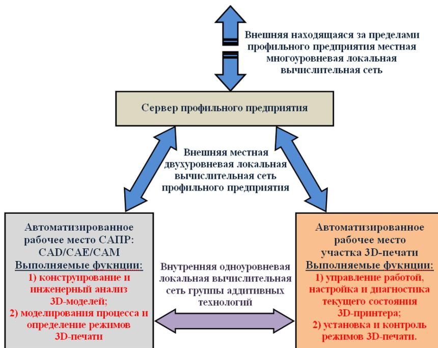
Рисунок 1.3 – Структурная схема организуемого на базе группы аддитивных технологий элементарного интегрируемого аддитивного производства
