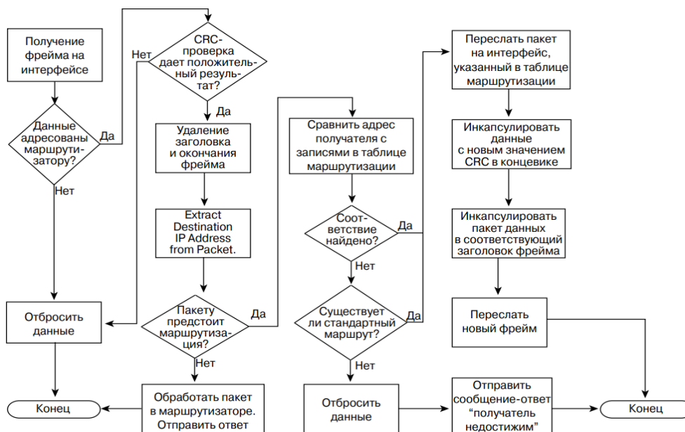
Рисунок 0.1 – Процесс трансформации данных в маршрутизаторе
