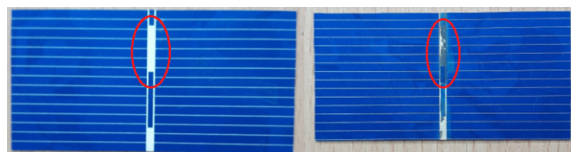
б) – вид контактных площадок до испытаний (слева) и после воздействия температуры испытаний 180° С (справа)
